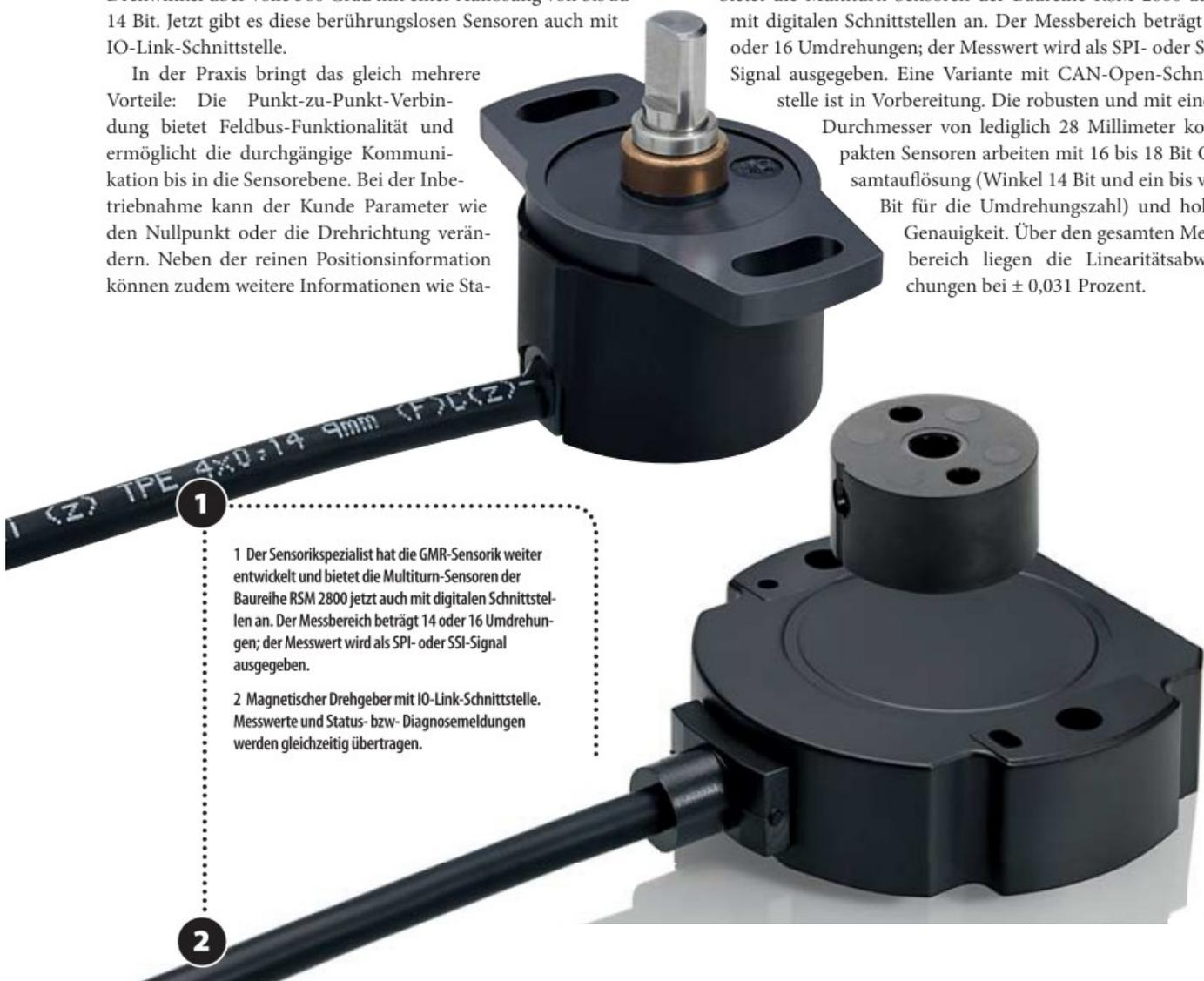
1 Der Sensorikspezialist hat die GMR-Sensorik weiterentwickelt und bietet die Multiturn-Sensoren der Baureihe RSM 2800 jetzt auch mit digitalen Schnittstellen an. Der Messbereich beträgt 14 oder 16 Umdrehungen; der Messwert wird als SPI- oder SSI-Signal ausgegeben.
